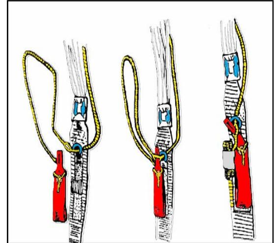
**#2** Verstauen Sie die Überlänge der Steuerleine unter dem Klett und legen anschließend das Klett der Steuerleinen-Schleifen auf das Klett des Tragegurttes.
