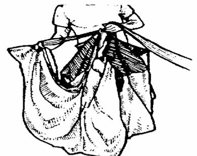
**#10** Ergreifen Sie nun die Steuerleinen einer Seite am Schirmende und ziehen Sie diese mit der Steuerkante aus der Kappe heraus. Legen Sie die Steuerkante in S-Schlägen zur Mitte hin ab. Wiederholen Sie den Vorgang auf der anderen Seite.
