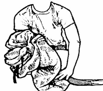
**#17** Falten Sie nun den oberen Teil des Kappenmaterials über Ihren Unterarm und drücken Sie die restliche Luft heraus, um es dann in einem entgegengesetzten S-Schlag auf den ersten zu legen. Sichern Sie das Kappenmaterial ständig mit einer Hand.
