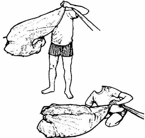
**#14** Sichern Sie mit beiden Knien die Basis des Cocon mit den Leinen und drücken vorsichtig die Luft nach oben aus dem Fallschirm heraus.
