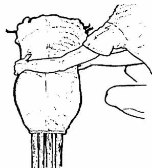
**#15** Achten Sie darauf das die Naht der Mittelzelle weiterhin in der Mitte bleibt. Abschließend legen sie sich kurz auf den Schirm um die Restluft heraus zu drücken.
